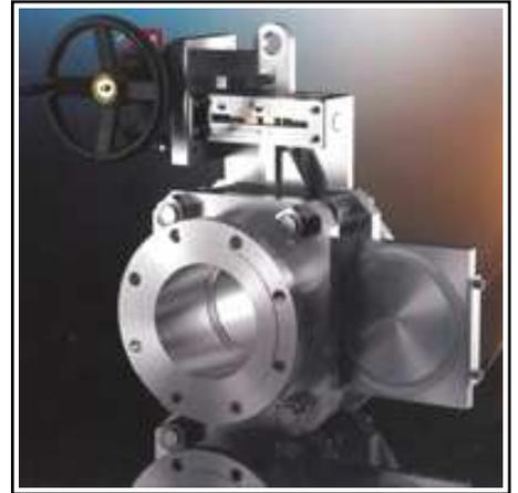
Seule la lunette est en contact avec le fluide. L'obturbateur est à passage intégral et peut supporter le raclage de la tuyauterie.
